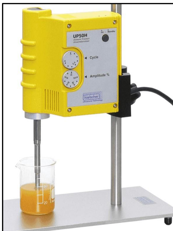
Figure 09 : L'extraction assistée par ultrason.
