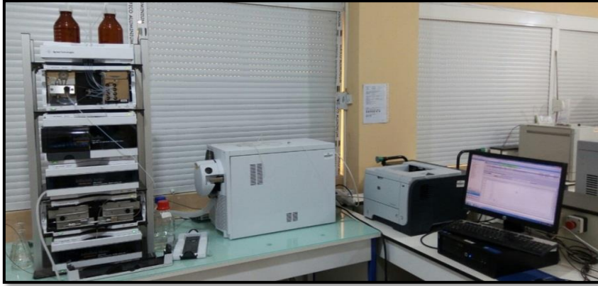
Figure 18 : La chromatographie liquide à haute performance (CLHP, Agilent).
